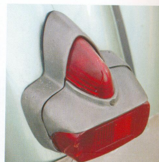
El cuentakilómetros cuadrado, el cajetín lateral y el nuevo piloto trasero corresponden a la gama de la Vespa 150 S de 1961.
